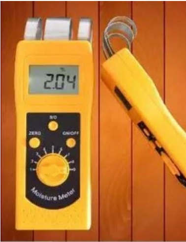
墙板含水率检测
