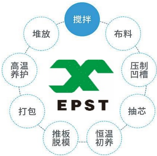
生产工艺流程图
